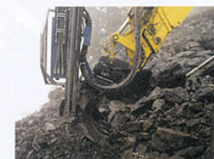
Kleinere Schaufelarbeiten können ohne Demontage der Bohrlafette ausgeführt werden.
