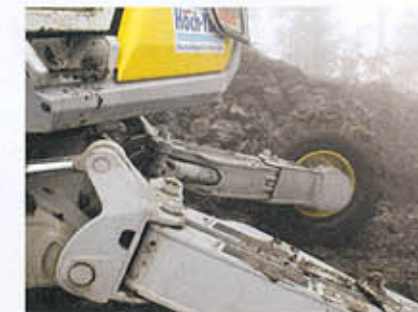
Zwei Räder sind hydrostatisch angetrieben. Der Unterbau ist massiv dimensioniert.
