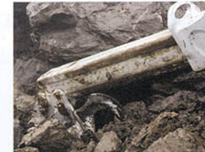
Bras télescopiques à griffes pour une tenue sûre dans tous les terrains.
