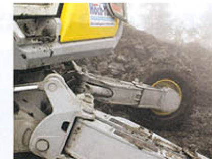
Deux roues sont à entraînement hydrostatique. Le châssis inférieur est surdimensionné.
