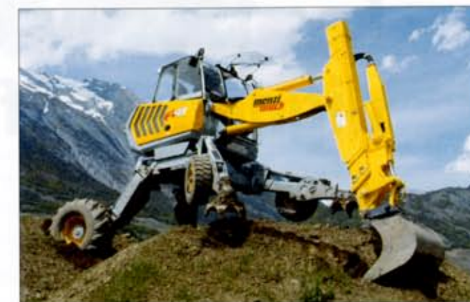
Avec son châssis spécial, la pelle A91 bénéficie d'une stabilité exceptionnelle.
