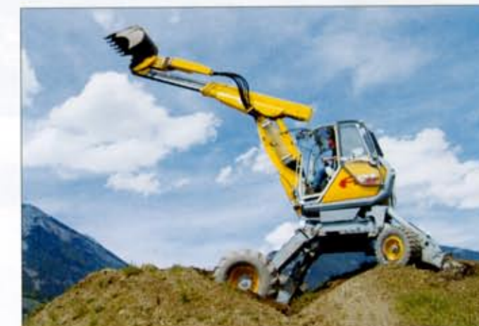
Le bras et les vérins hydrauliques imposants offrent à la pelle A91 envergure et grande force de levage et d'excavation.
