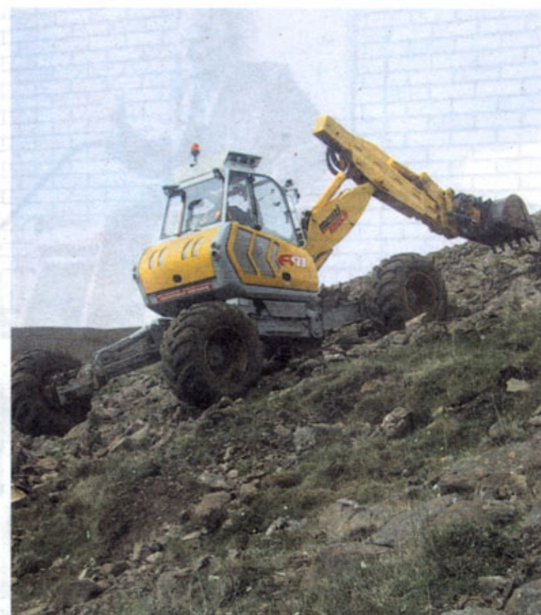
Í Kjós Eyþór Arnórsson að störfum í hlíðinni fyrir ofan Reynivelli í Kjós þar sem hann var að nota vélina til þess að rétta rafmagnsstaura sem voru farnir að halla undir flatt.
