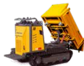
Der 3-Seitenkipper Menzi Max 10dk mit 1000 kg Nutzlast ist auch als Rundkipper erhältlich.
