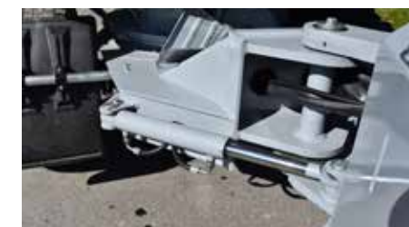
Articulation centrale robuste: angle de flambage +/- 35° et angle pendulaire +/- 12°
