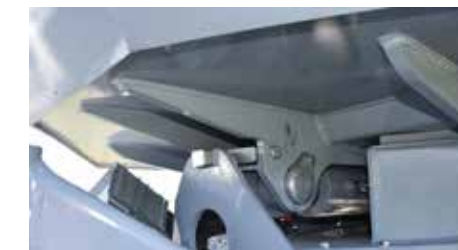
Le dispositif de verrouillage mécanique sécurise la benne lors du chargement et du déplacement.
