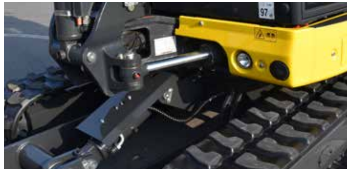
Massiver Schwenkteil aus spannungsfreiem Stahlguss mit gross dimensionierten Bolzen und geschütztem Schildzylinder
