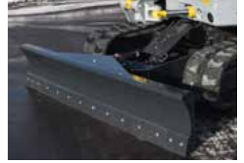
Robuster, hydraulischer Frontschild mit starkem Zylinder, Kantenschoner und Verbreiterungsmöglichkeit, optional mit Schwenkfunktion.
