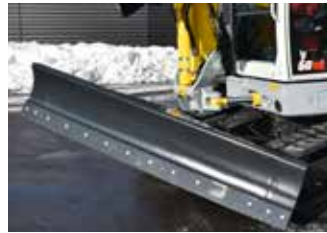
Robuster, hydraulischer Frontschild mit starkem Zylinder, Kantenschoner und Verbreiterungsmöglichkeit, optional mit Schwenkfunktion.
