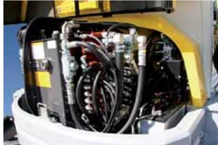
*Sämtliche Motor- und Hydraulikkomponenten sind frei zugänglich und der neue Entlüftungsknopf vereinfacht den Service zusehens.*
