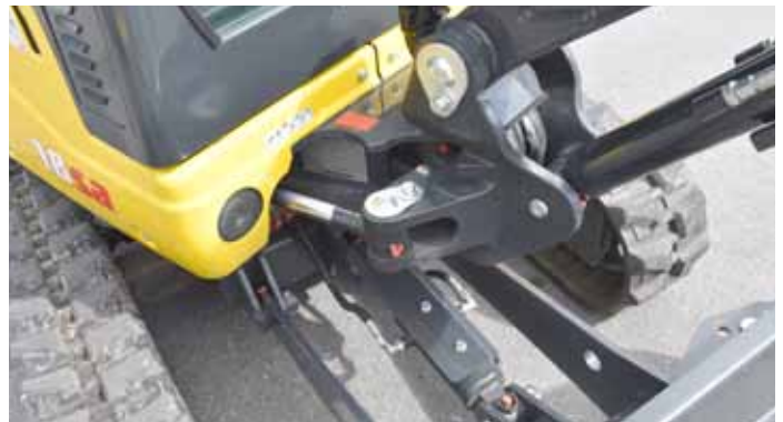
Massiver Schwenkteil mit geschütztem Schildzylinder
