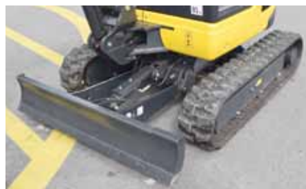
Massiver Schwenkteil mit geschütztem Schildzylinder
